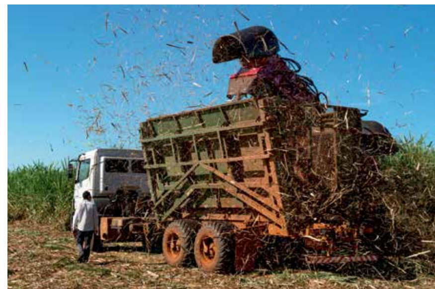
Ex-cortadores de cana agora trabalham na adubação (acima). O trabalho pesado de colheita ficou para máquinas adaptadas ao cultivo orgânico, dotadas de pneus de alta flutuação (abaixo). A mudança acabou com as queimadas e com a compactação do solo.
